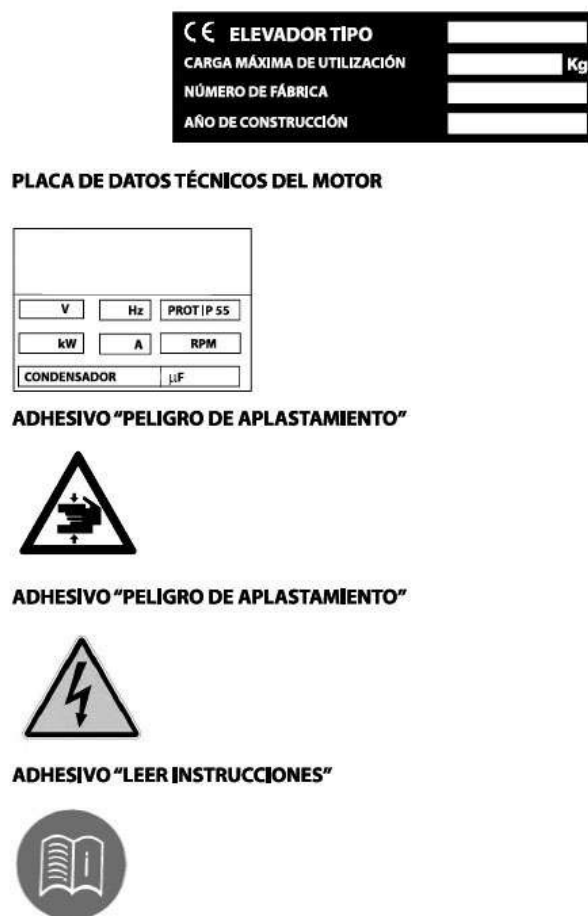
FIG. 2 — Placas y adhesivos presentes en el elevador
