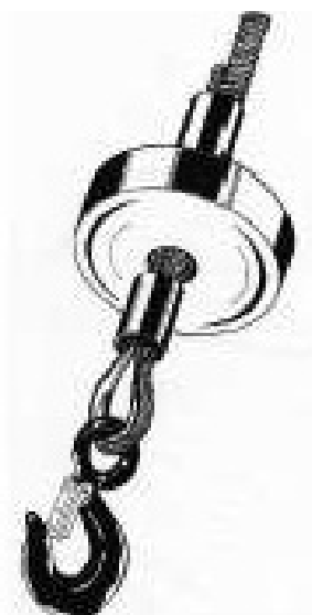
FIG. 11 — Fijación del cable con manguitos de aluminio
