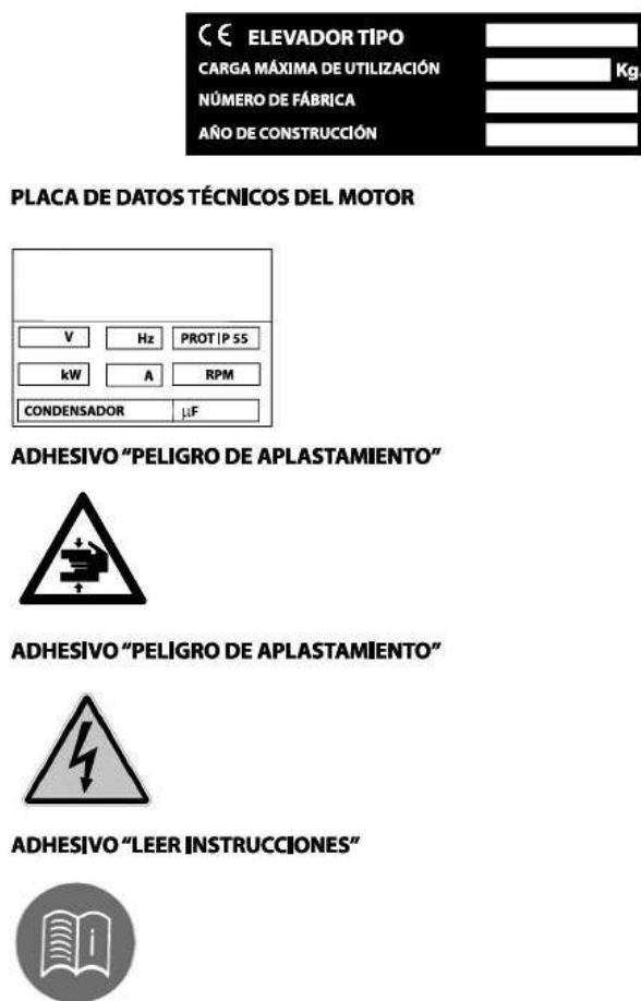
FIG. 2 — Placas y adhesivos presentes en el elevador
