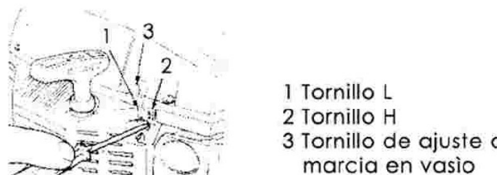
FIG. 13 — Tornillos del carburador: 1, tornillo L; 2, tornillo H; 3, tornillo de ralentí (T)
