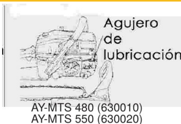
FIG. 22 — Situación del agujero de lubricación
