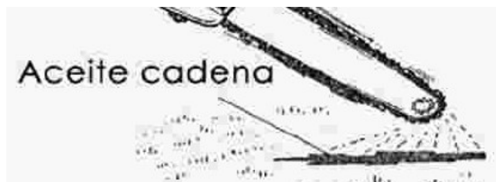
FIG. 11 — Comprobación de la proyección del aceite de cadena
