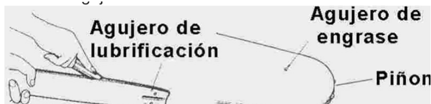
FIG. 23 — Agujero de lubricación, agujero de engrase y piñón de punta
