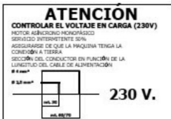
FIG. 10 — Placa de advertencia: control del voltaje en carga y sección del conductor
