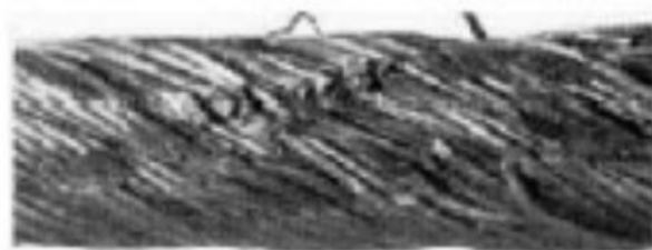
FIG. 14.1 — Rotura de hilos en varios haces adyacentes de un mismo cable con enrollamiento cruzado (garganta de la polea demasiado estrecha). Dicho estado requiere la sustitución.
