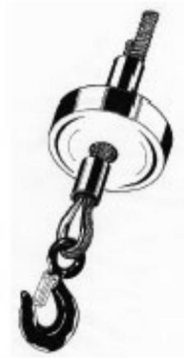
FIG. 15 — Fijación del cable con manguitos de aluminio
