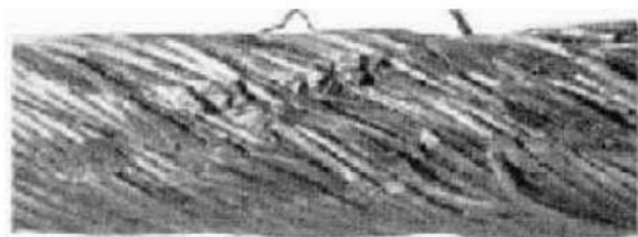
FIG. 7.2 — Grave desgaste y número notable de hilos rotos. Rozamiento bajo tensión sobre arista viva. Dicho estado requiere la sustitución inmediata.
