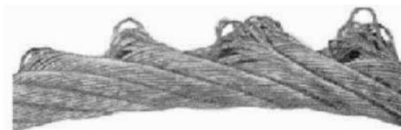
FIG. 7.3 — Grave defecto localizado con salida de los cables interiores de los haces, a causa de repetidos tirones. Dicho estado requiere la sustitución inmediata.
