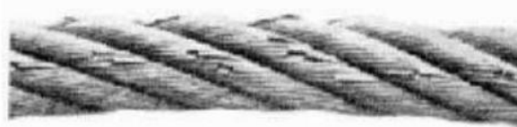
FIG. 7.1 — Rotura de hilos en varios haces adyacentes de un mismo cable con enrollamiento cruzado (garganta de la polea demasiado estrecha). Dicho estado requiere la sustitución.
