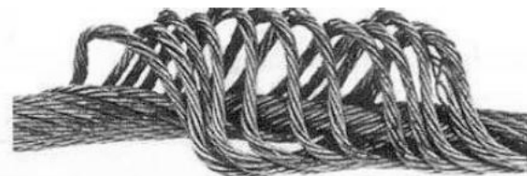
FIG. 7.5 — Abombamiento causado por rotación forzada por gargantas demasiado estrechas o excesivo ángulo de desviación. Dicho estado requiere la sustitución inmediata.
