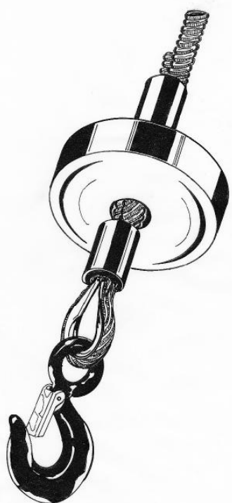
FIG. 8 — Fijación del cable con manguitos de aluminio
