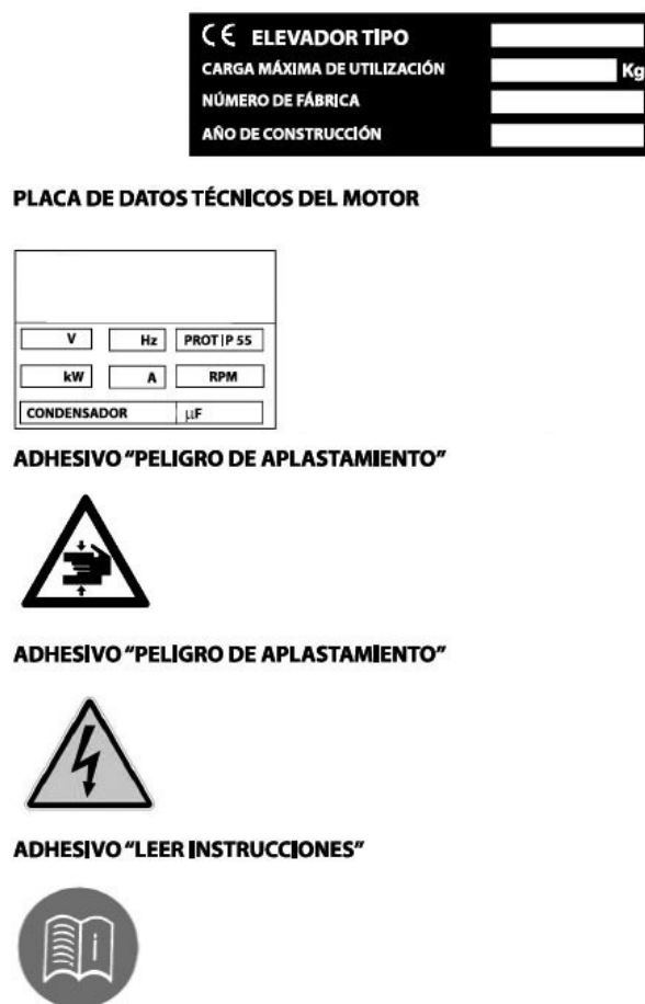
FIG. 2 — Placas y adhesivos presentes en el elevador
