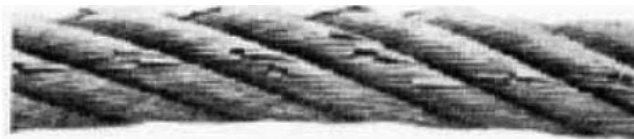
FIG. 9.1 — Rotura de hilos en varios haces adyacentes de un mismo cable con enrollamiento cruzado (garganta de la polea demasiado estrecha). Dicho estado requiere la sustitución.
