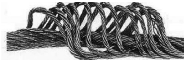
FIG. 9.5 — Abombamiento causado por rotación forzada por gargantas demasiado estrechas o excesivo ángulo de desviación. Dicho estado requiere la sustitución inmediata.
