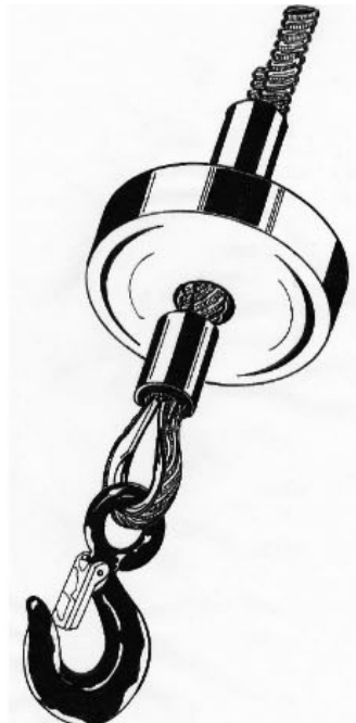
FIG. 10 — Fijación del cable con manguitos de aluminio
