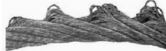
FIG. 9.3 — Grave defecto localizado con salida de los cables interiores de los haces, a causa de repetidos tirones. Dicho estado requiere la sustitución inmediata.
