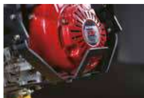
PROTECTION MÉTALLIQUE LATÉRALE DU MOTEUR. LATERAL METALLIC PROTECTION OF MOTOR.
